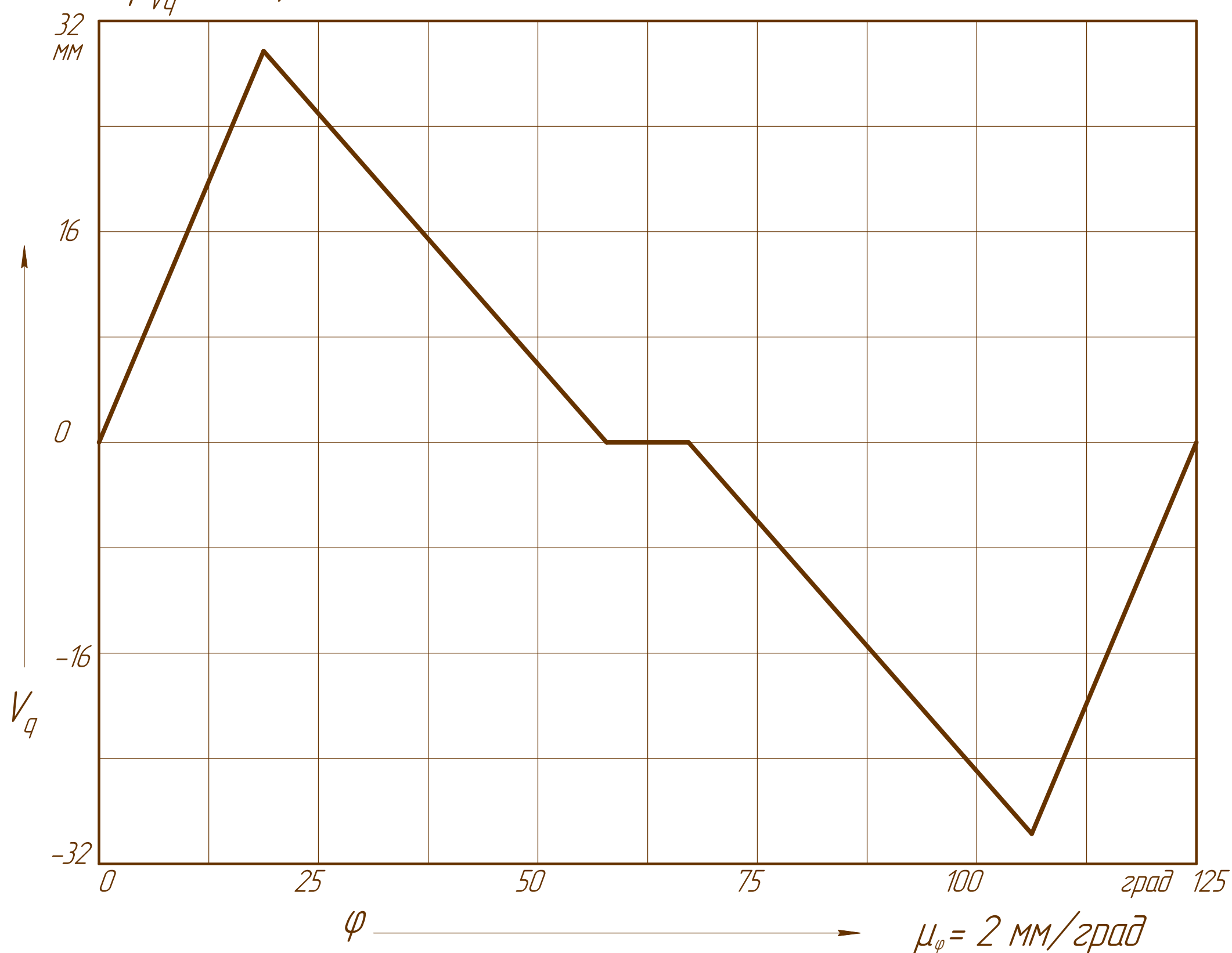
Аналог скорости толкателя \mu_{Vq} = 3 \text{ мм/мм}
