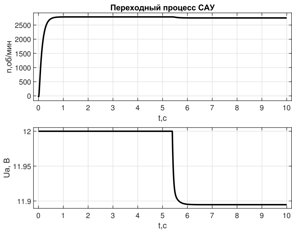
Рисунок 1.7 — Переходный процесс САУ - максимальная нагрузка
